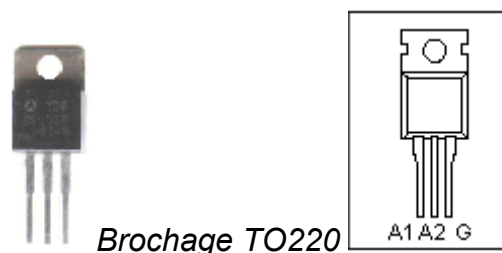
Figure 3.5-4 Exemple d'un boîtier de triac
