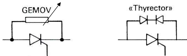
Figure 3.4-5 Protection des SCR contre les surtensions
